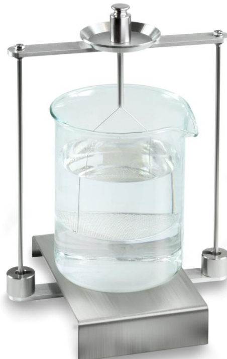
Abb.5: Wägung in Luft
