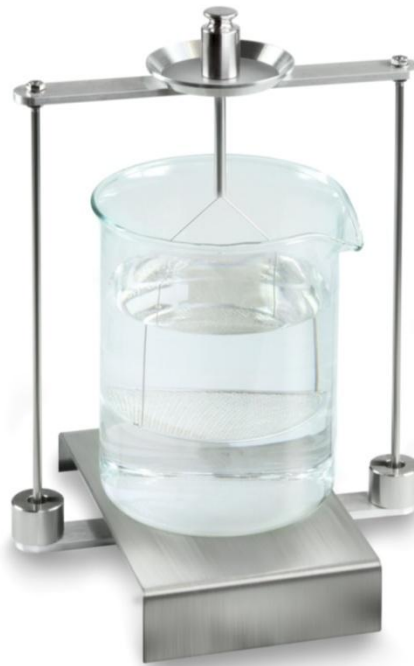
Abb.1: „Wägung in Luft“
