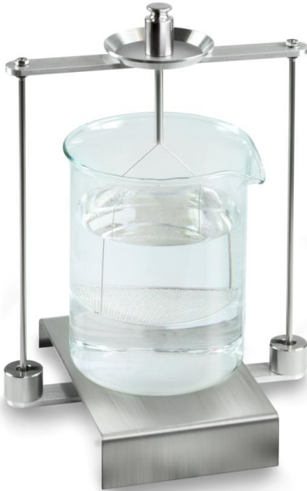
Abb.5: Wägung in Luft
