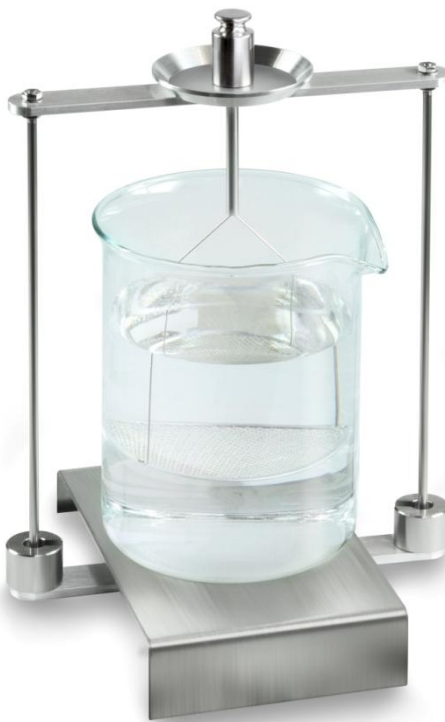
Abb.1: Wägung in Luft
