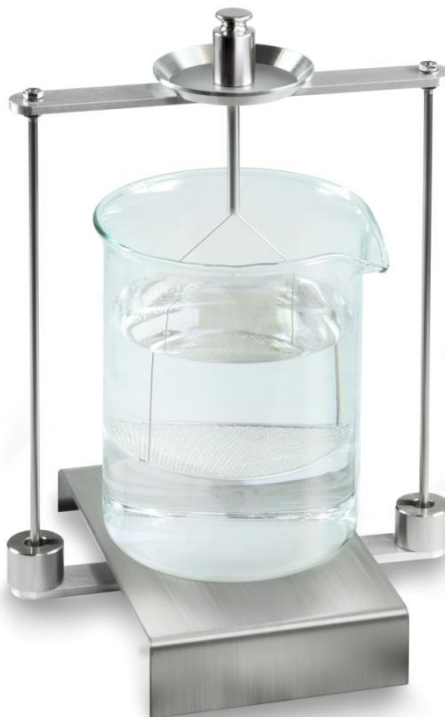
Abb.1: Wägung in Luft
