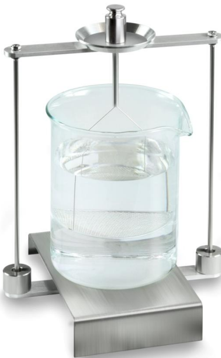
Abb.1: Wägung in Luft
