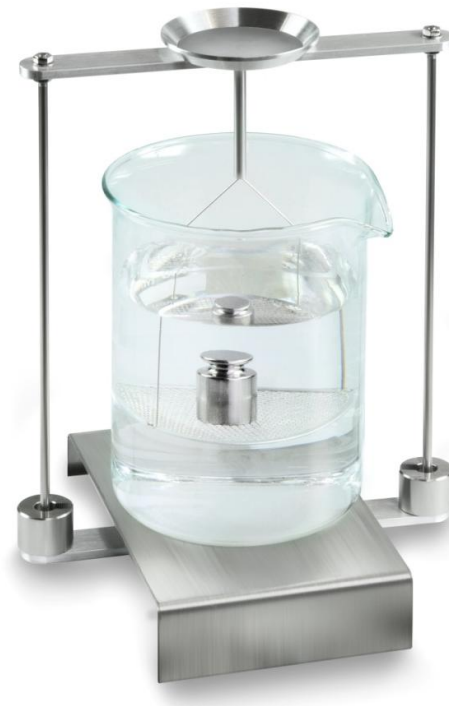
Abb.6: Wägung in Prüfflüssigkeit
