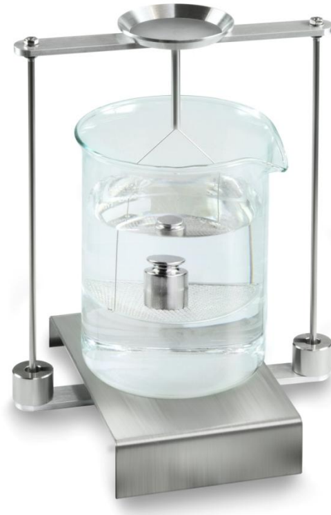
Abb.2: Wägung in Hilfsflüssigkeit
