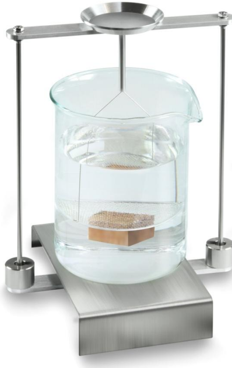
Abb.4: Wägung in Hilfsflüssigkeit
